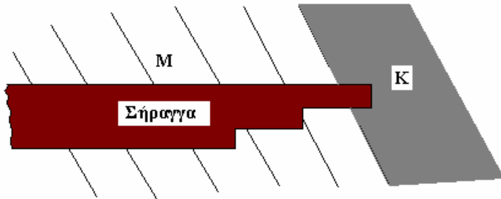
Σχ. 1.5. Μετάβαση από ένα τύπο πετρώματος (Μ) σε άλλο μαλακό πέτρωμα (Κ) κατά την διάνοιξη της σήραγγας. Η αστοχία έχει μεγάλη πιθανότητα να εκδηλωθεί στην επαφή των δύο πετρωμάτων.
